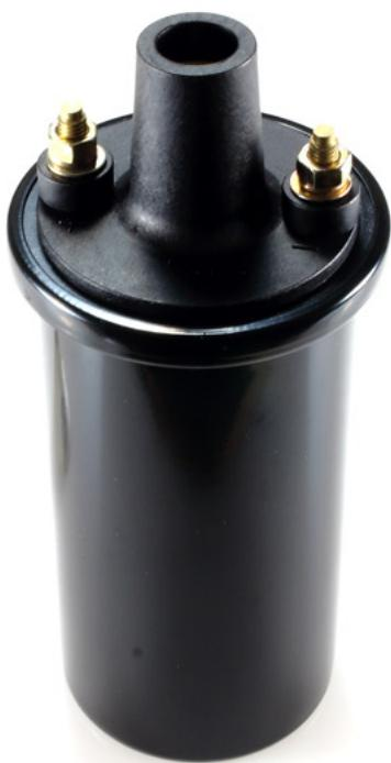
Equivalencias: UNIVERSAL 12V C/encendido a platinos y resistor externo
