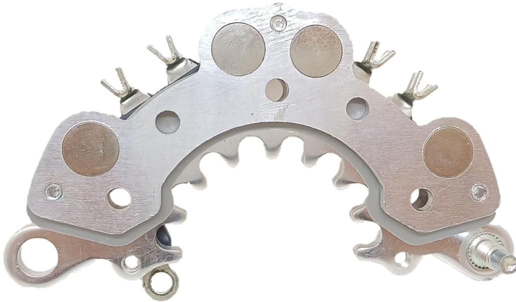
Puente tipo Hitachi: LR190-742, 8 diodos sin placa auxiliar.
